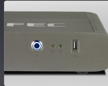
维修快速 电源键、网络状态指示灯、硬盘指示灯、 USB插槽都在机身正面
